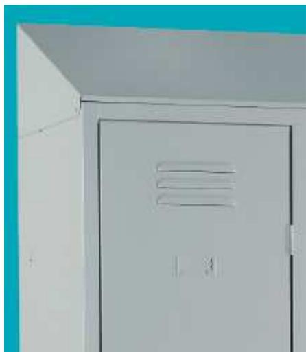
Tetto spiovente antipolvere, costruito in lamiera d'acciaio spessore 6/10, con tutti i bordi raggiungibili ripiegati. Verniciato a polveri epossipoliesteri di colore grigio Ral 7035. Dotato di predisposizione rapida per il fissaggio all'armadio, tramite biadesivo fornito in dotazione.
